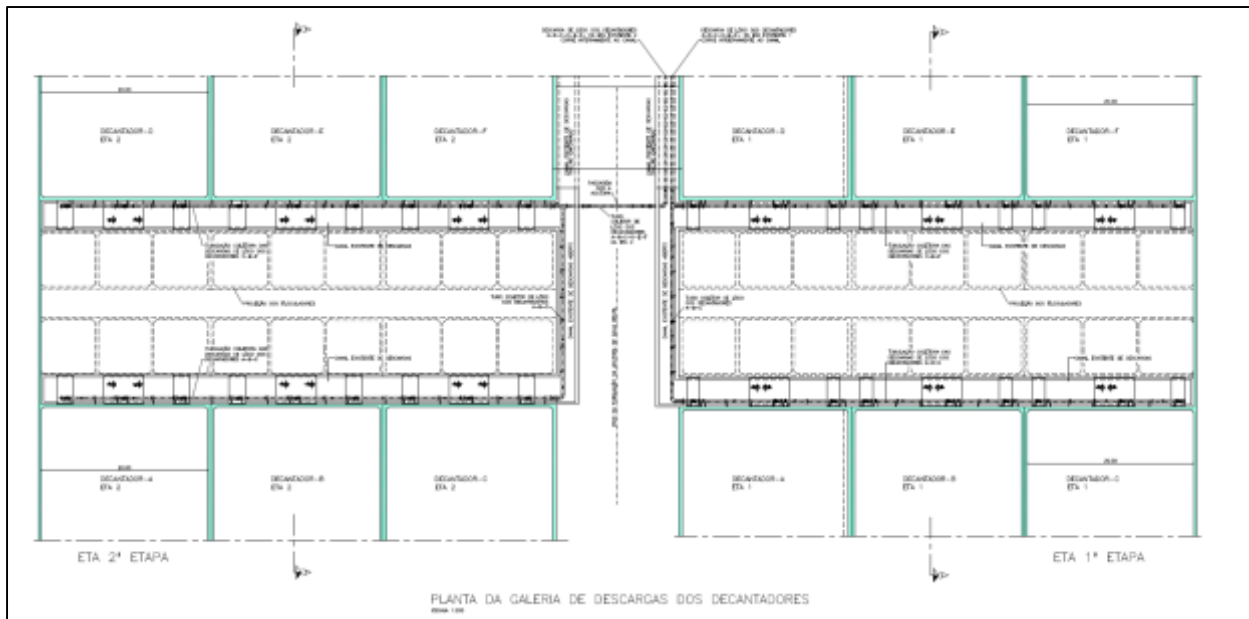
Figura 4.14 – Vista geral do canal comum de recebimento de água de lavagem dos filtros e descarga de lodo dos decantadores
