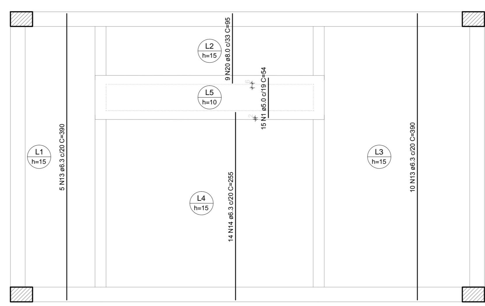
Armação positiva das lajes do Cintamento (Eixo Y) escala 1:30
