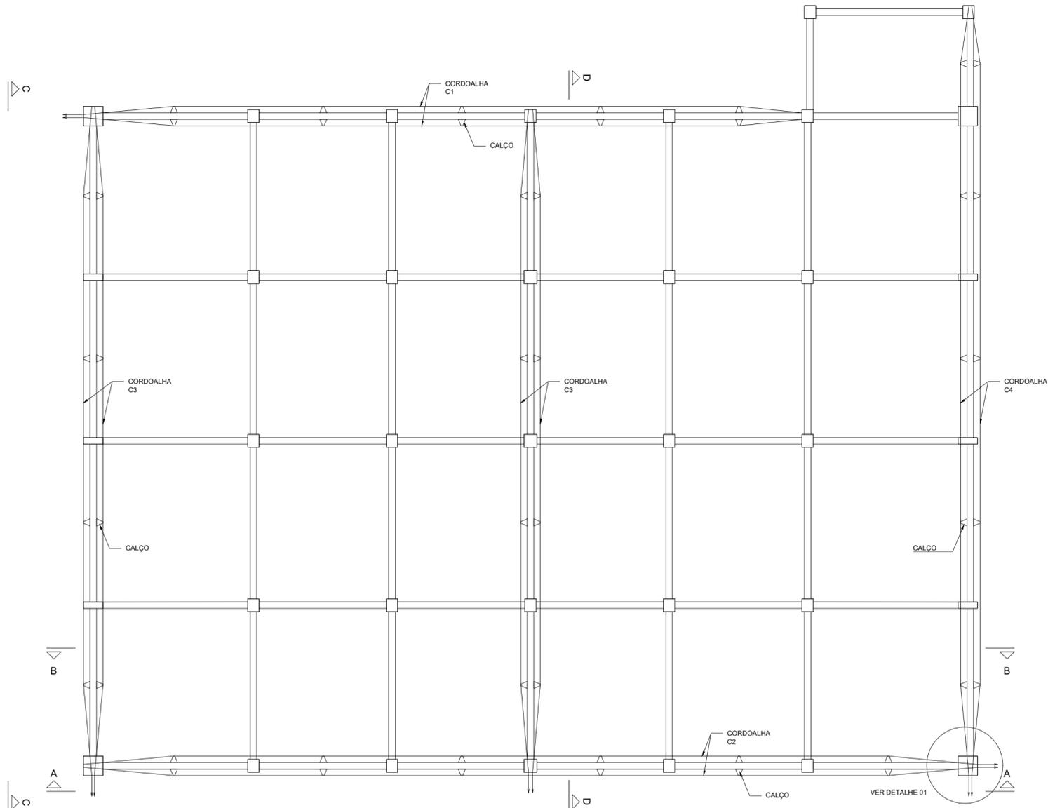
REFORÇO EM PLANTA DAS PAREDES COM POSICIONAMENTO DOS CALÇOS E CORDOALHAS
