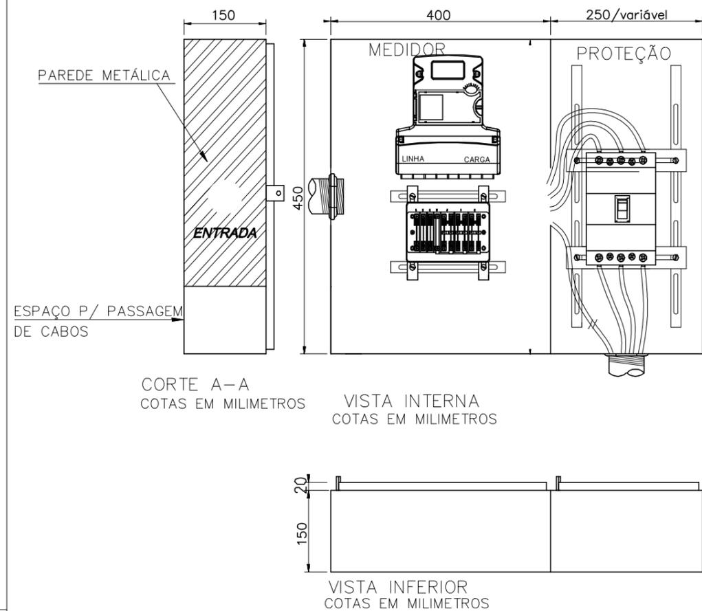
DETALHE – CAIXA DE MEDIÇÃO E PROTEÇÃO S/ESC.
