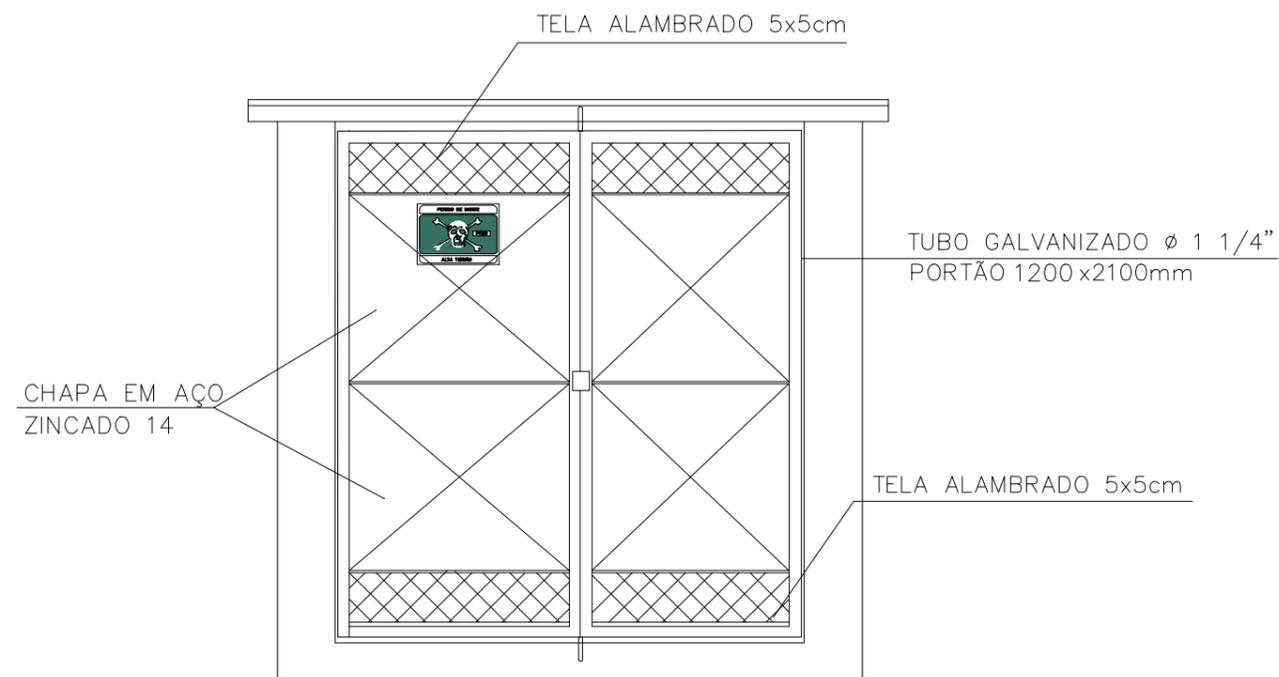
DETALHE DO PORTÃO DO ABRIGO DO PAINEL DE COMANDO DO MOTOR S/ ESC.
